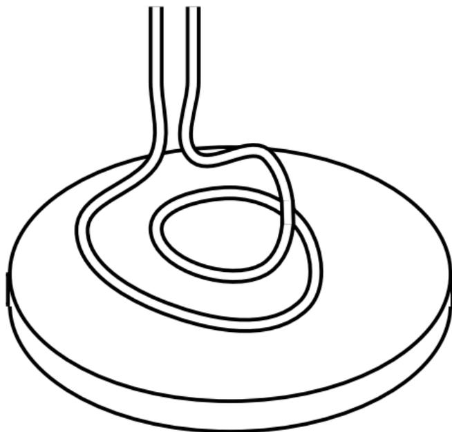
Un inducteur est disposé de manière que son induction source puisse traverser la pièce conductrice dans une direction normale à ses plus grandes dimensions.
