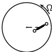
Le mouvement est dissipatif avec une fonction de dissipation  $D = \frac{1}{2} r \dot{d}^2$  où  $d$  est la distance entre les deux masses.
