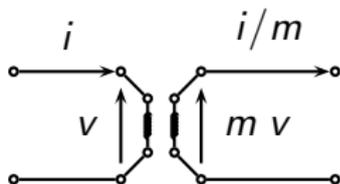
qui multiplie la tension par  $m$  et corrélativement divise le courant par  $m$  ( $m$  est un coefficient sans dimension, pas une mutuelle) corrigé par la présence de l'inductance de magnétisation  $l$ , de la résistance de pertes fer  $R$ , des inductance de fuite  $\lambda$  et résistance d'effet Joule  $r$  (primaire ramené au secondaire).
