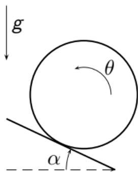
Une boule de masse  $m$  est posée sur une pente, elle est initialement immobile. Les coefficients de frottement de la matière de la boule avec celle de la pente sont  $f_0$  et  $f$  dans les cas statique et dynamique. Avec  $f < f_0$ .
