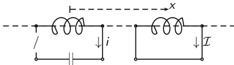
Le condensateur est chargé et l'interrupteur est fermé à l'instant initial.
