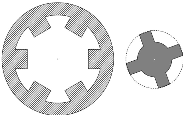
Trois bobines 1, 2, 3 sont enroulées autour des plots 1-4, 2-5, 3-6 au stator ; le rotor est placé dans le stator, il peut tourner et son angle de rotation est  $\theta$ .
