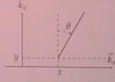
Le bâton et le même problème précédant sont considérés. On souhaite connaître la force de réaction du plan horizontal sur l'extrémité O. Pour cela on introduit une variable de configuration supplémentaire y. Les énergie cinétique et potentielle sont modifiées comme
